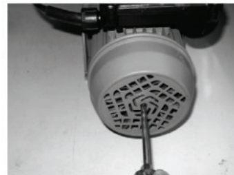
Para evitar bloqueo del sello mecánico, hacer girar el eje a través del ventilador antes de la puesta en marcha o después de una inutilización prolongada!
