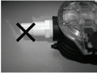
Ne pas utiliser de réduction au niveau des bouches d'aspiration et d'impulsion
