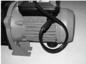
CORRECT! Evite l'entrée de l'eau par le câble électrique.
