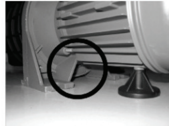
Verificar regularmente la estanqueidad! (Una fuga por el sello mecánico provoca daños importantes!)
